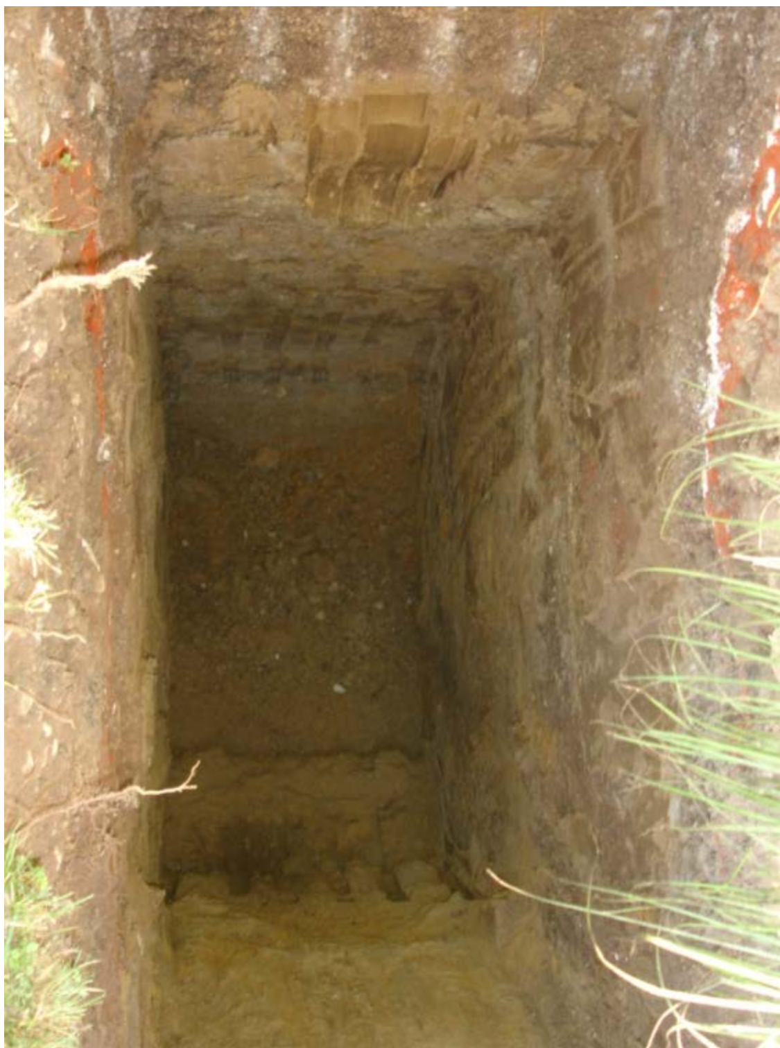
Pogled v dno sondažnega jaška na globini -4,50m.
